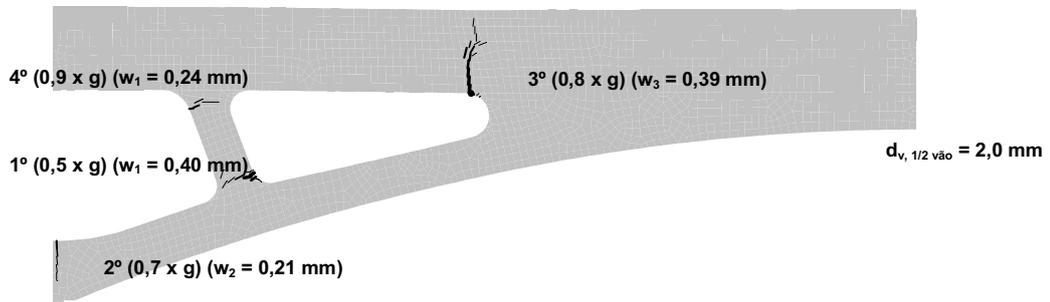
Fig. 4.3 - Non linear analysis. Cracking
